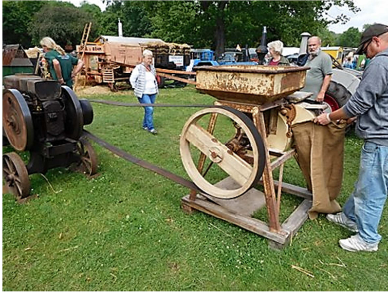
Dieselmotorgetriebene Schrotmühle mit Riementransmission
