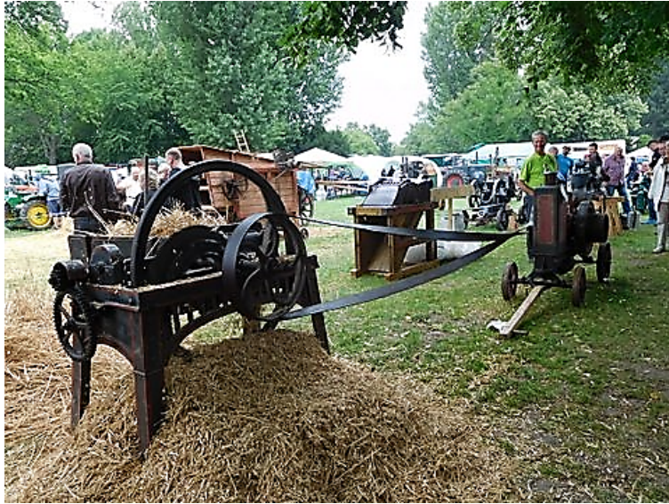
Strohschneidemaschine zum Zerschneiden von Stroh zu Siede
