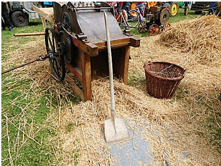
Dreschtrommel zum Heraus-„dreschen“ der mit Spreu und Stroh vermischten Körner
