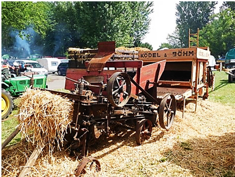
Lanzbulldogbetriebene mobile Dreschmaschinen mit separater Strohpresse
