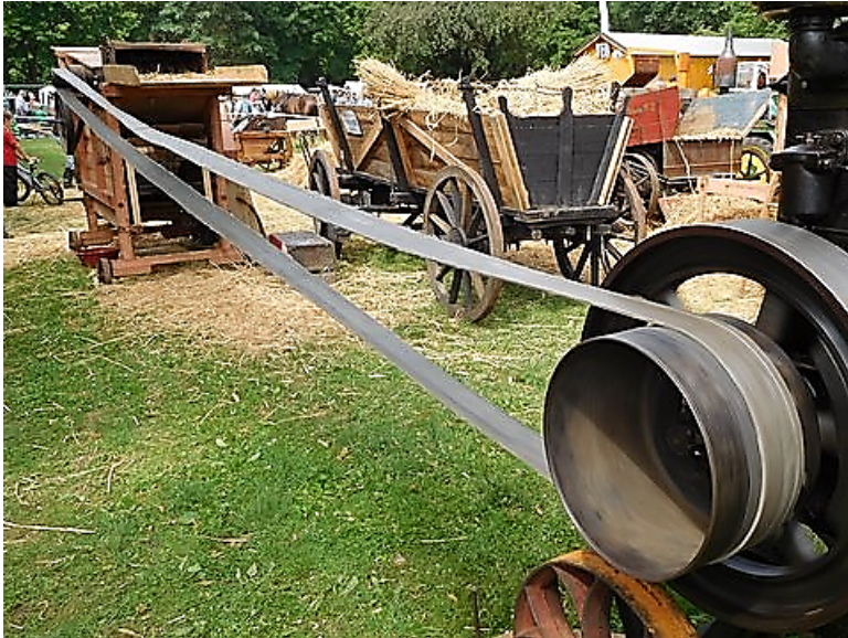
Standmotor-getriebener Hordenschüttler zum Abtrennen des Strohs von Körnern und Spreu
